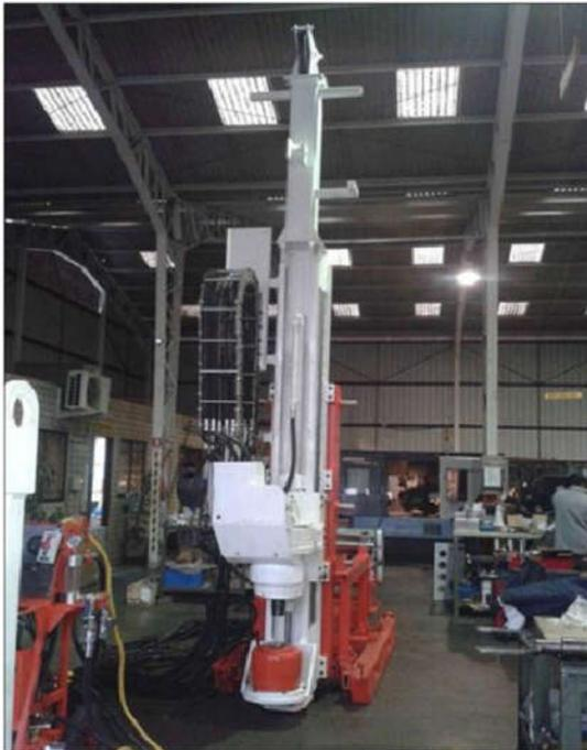
*Equipo de perforación funcionamiento 100% oleo hidráulico y de construcción modular, diseñado específicamente para perforación diamantina (Diamond Core Drill). El equipo ha sido diseñado para el montaje sobre patines o sobre orugas autopropulsadas. La construcción modular permite desmontar el equipo en unidades de menor peso, para el transporte individual de este a lugares de difícil acceso.*
